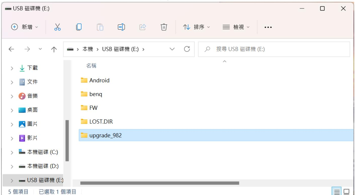
5. 將 IFP 觸控顯示器正常關機，插入該隨身碟到 USB 孔，按住電源鍵不放，約十餘秒畫面出現後，再放開電源鍵，並靜待更新完成（過程大約 10 分鐘，完成之前請勿關機或斷電，以免更新失敗）。
