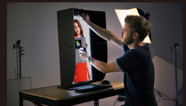
↑接続が済んだらキャリブレーションを行います。遮光フードの上部を外したら、測色計をセットし、専用ソフトを起動して実行するだけ。モニターの使用時間が200時間を超えたら補正するのが理想です。
