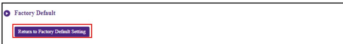
Wenn der Vorgang bestätigt wird, beginnt der Host mit der Wiederherstellung der **Werkseinstellung** und die LED wird schnell rot blinken (zwei Mal pro Sekunde rot blinken) und anschließend neu starten. Nach dem Neustart des Host ist der komplette Vorgang abgeschlossen.
