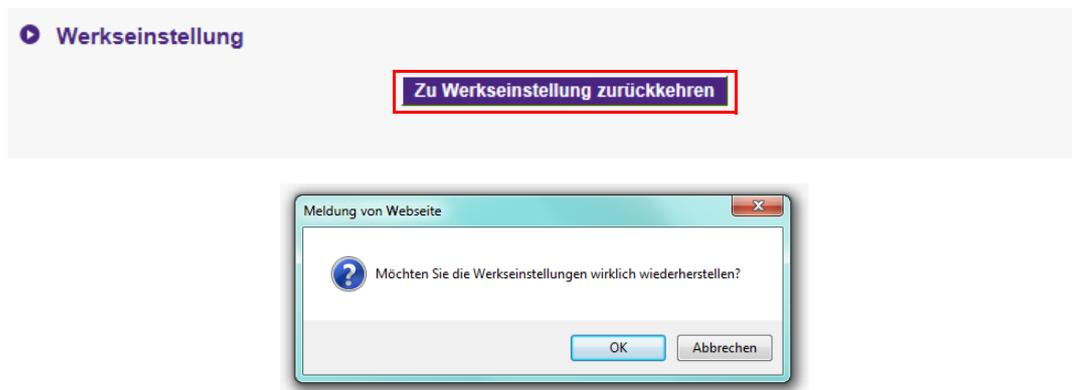
Wenn der Vorgang bestätigt wird, beginnt der InstaShow Host mit der Wiederherstellung der **Werkseinstellung** und die LED wird schnell rot blinken (zwei Mal pro Sekunde rot blinken) und anschließend neu starten. Nach dem Neustart des InstaShow Host ist der komplette Vorgang abgeschlossen.
