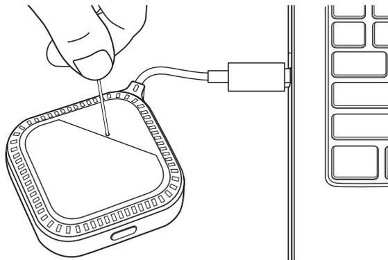
4. Die InstaShow Button LED wird beginnen, 10 Sekunden lang schnell rot zu blinken (pro Sekunde zwei Mal rot blinken), anschließend 15 bis 20 Sekunden lang leuchten, um anzuzeigen, dass der InstaShow Button zurückgesetzt wird.
