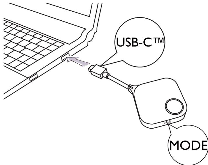
2. Wenn der InstaShow Button mit einem Laptop verbunden ist, wird die LED-Anzeige des InstaShow Button rot blinken. Der InstaShow Button befindet sich im Kopplungsmodus und wartet auf die Kopplung mit dem InstaShow Host.
