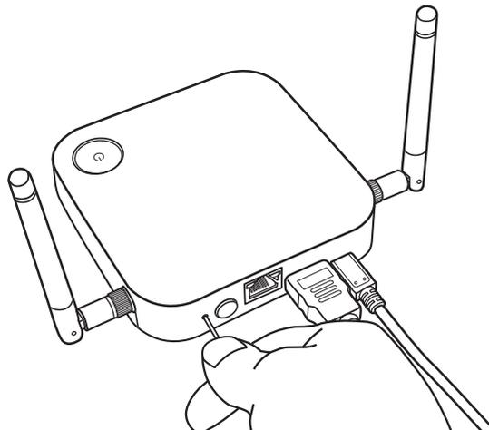
3. Die InstaShow Host LED wird beginnen, 10 Sekunden lang schnell rot zu blinken (pro Sekunde zwei Mal rot blinken), anschließend 15 bis 20 Sekunden lang leuchten, um anzuzeigen, dass der InstaShow Host zurückgesetzt wird.
