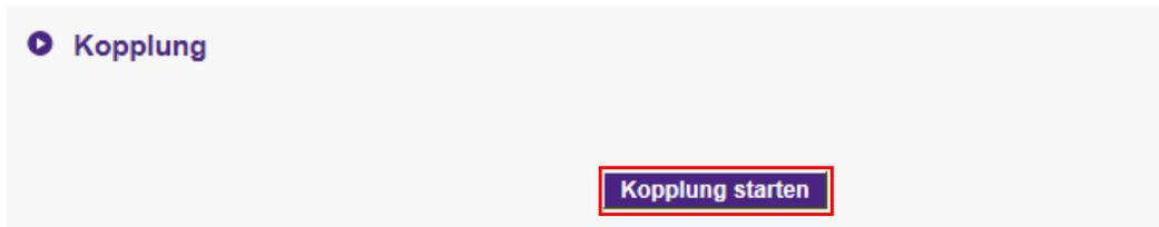
5. Drücken Sie fünf Sekunden lang auf die **MODE** Taste an der Seite des InstaShow Button. Die LED-Anzeige des InstaShow Button wird etwa 10 Sekunden lang blau blinken. Der Kopplungsvorgang wird ausgeführt. Die "Kopplung" Meldung wird auf dem Bildschirm angezeigt.
